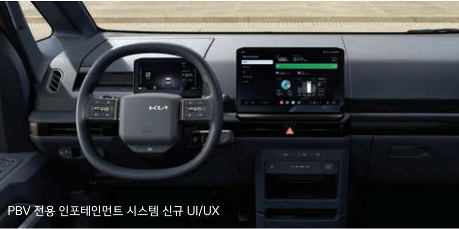
PBV 전용 인포테인먼트 시스템 신규 UI/UX 12.9인치, 16:9 비율의 대화면 PBV 전용 디스플레이로 혁신적인 비즈니스 차량 경험을 지원합니다.
