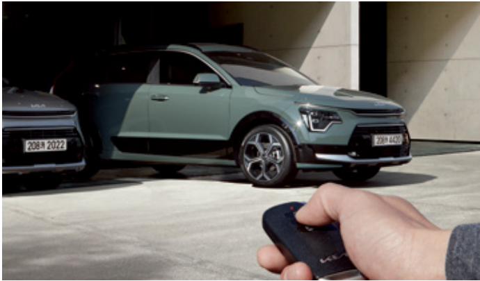
원격 스마트 주차 보조 차량 외부에서 차량을 전진 또는 후진 제어하여, 원격으로 주차 및 출차하도록 도와줍니다.
