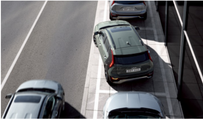
후측방 충돌 경고, 후측방 충돌방지 보조 (전진 출차) 차로 변경을 위하여 방향지시등 스위치 조작 시, 후측방 차량과 충돌 위험이 감지되면 경고를 해 줍니다. 평행 주차 상태에서 전진 출차 중 후측방 차량과 충돌 위험이 감지되면 자동으로 제동을 도와줍니다.
