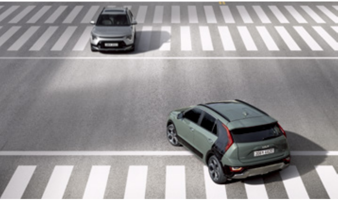
전방 충돌방지 보조 (차량, 보행자, 자전거 탑승자, 교차로 대향차) 선행 차량이 갑자기 속도를 줄이거나 앞에 정지 차량, 보행자 또는 자전거 탑승자가 나타나는 등 전방 충돌 위험이 감지되면 경고를 해줍니다. 경고 후에도 충돌 위험이 높아지면 자동으로 제동을 도와줍니다. 주행 중 교차로에서 좌회전 시 맞은편에서 다가오는 차량과 충돌 위험이 있다면 자동으로 제동을 도와줍니다.
