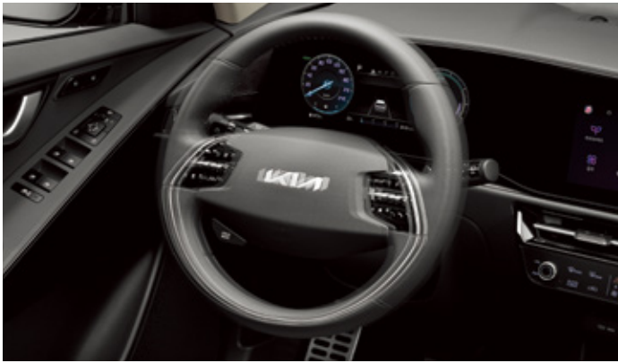
스티어링 휠 진동 경고* 주행 중 전방, 후측방에서 충돌 위험이 감지되거나 운전자 주의가 필요할 시 스티어링 휠 진동을 통해 직관적으로 위험 상황을 알려주고 더욱 안전한 주행을 도와줍니다.
