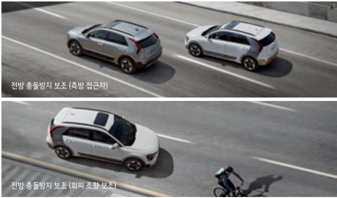
전방 충돌방지 보조 (교차 차량, 추월시 대향차, 측방 접근차, 회피 조향 보조) ※ EV 전용 교차로의 좌/우측에서 다가오는 차량과 충돌 위험이 있는 경우에도 자동으로 제동을 도와줍니다. 주행 중 차로를 변경하는 상황에서 맞은편에서 다가오는 차량 및 옆 차로의 차량과 충돌 위험이 높아지면 자동으로 회피 조향을 도와줍니다. 주행 중 전방에서 보행자 및 자전거 탑승자가 차로 가장자리에 들어와 있어 충돌의 위험이 있는 경우에도 자동으로 회피 조향을 도와줍니다.
